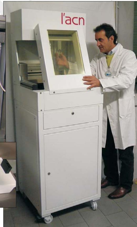
Il preparatore di dosi radioattive mod. GammaFis (FIS = Frazionatore per Isotopi) è un piccolo robot programmato per prelevare, da un flacone contenente liquido isotopico, una corretta quantità da iniettare ad un paziente soggetto a diagnosi o terapia nell'ambito di un Centro di Medicina Nucleare.
